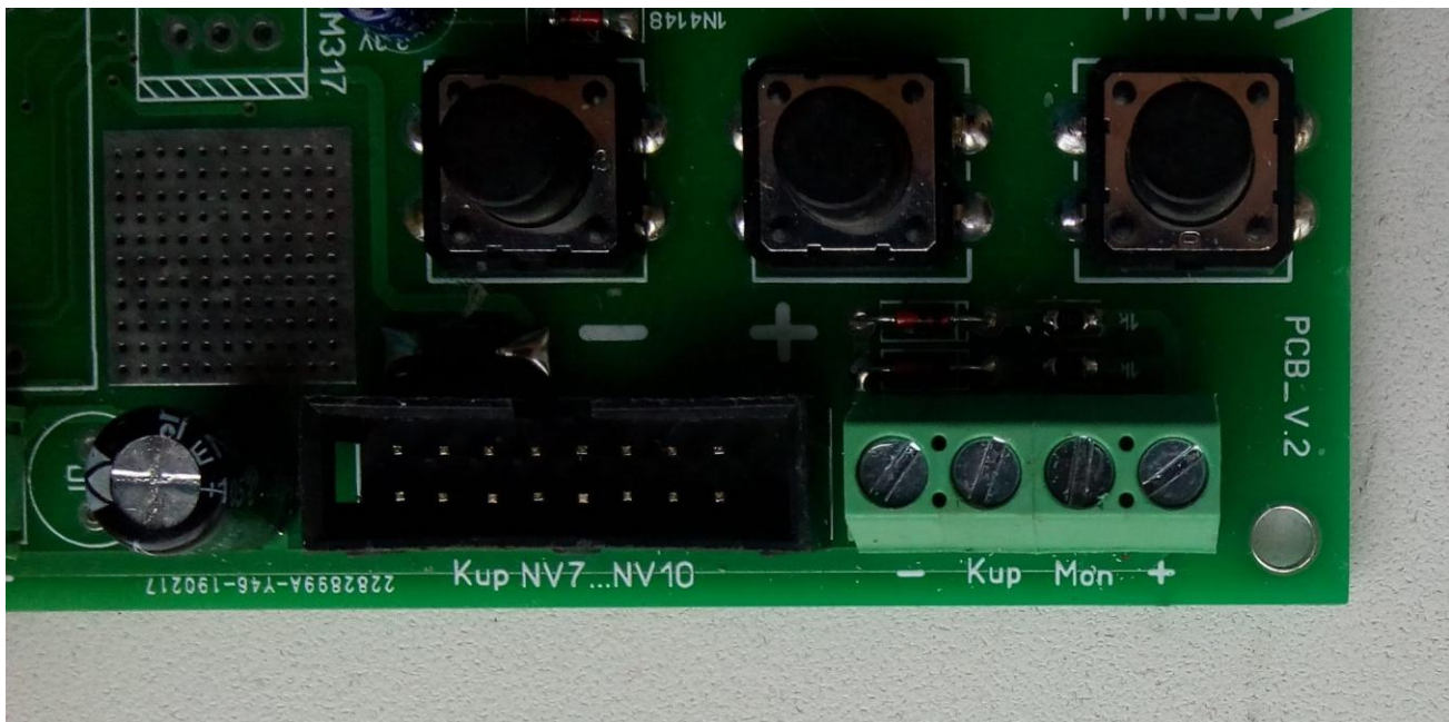
Рис.2 – Колодка для подключения купюро и монетоприемника
