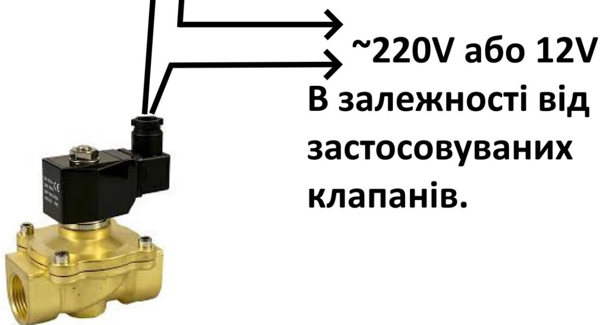
Рис.4 – Підключення електромагнітних клапанів до дозатору DOZA-4V
